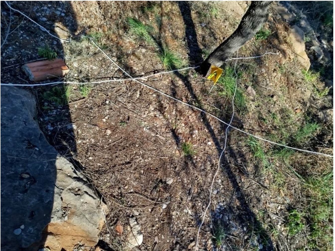
Banderola señalando el segundo punto. Se pueden ver las tres cuerdas utilizadas para marcar los rumbos
